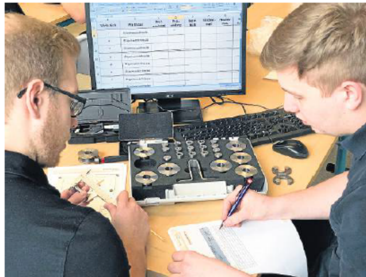
Die Azubis erhalten zuerst den Arbeitsauftrag zur Prüfung der Umlenkrolle. Dann werden ein Prüfplan erarbeitet und die Einzelteile geprüft. Am Schluss dann die Auswertung.
